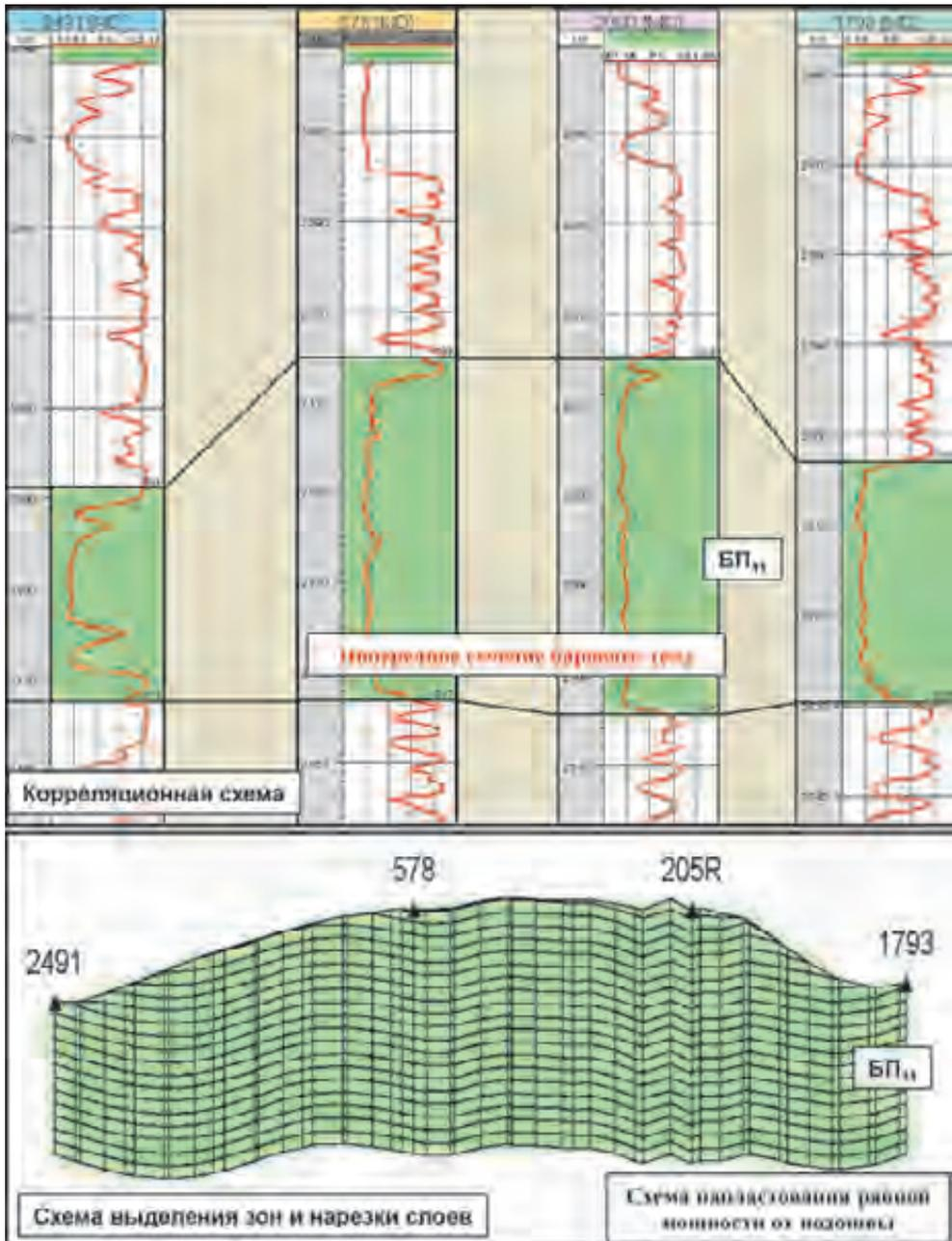
Рис.4.16. Пример обоснования зон и схемы нарезки слоев.
