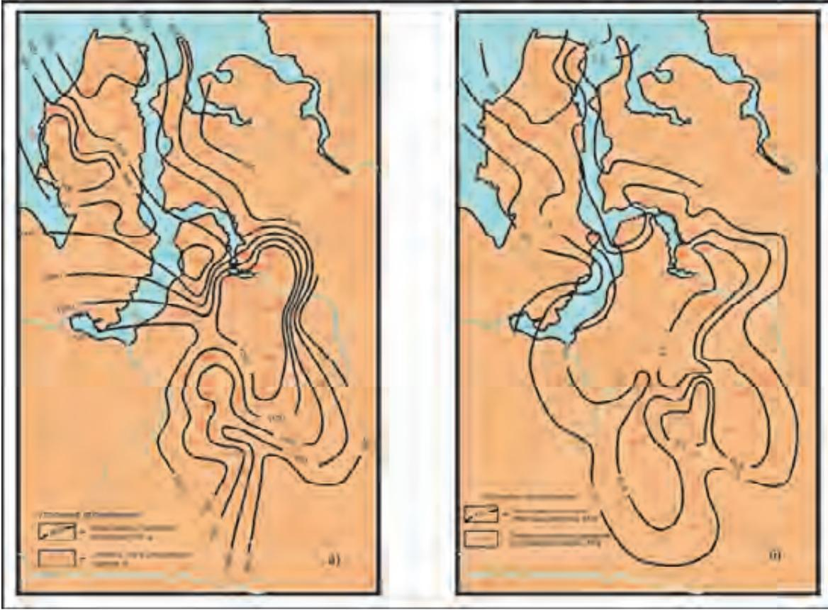
Рис. П.2.12. Карты начального положения ГВК (а) и начальных пластовых давлений (б) сеноманских газовых залежей севера Западной Сибири (материалы М.В.Пороскуна)
