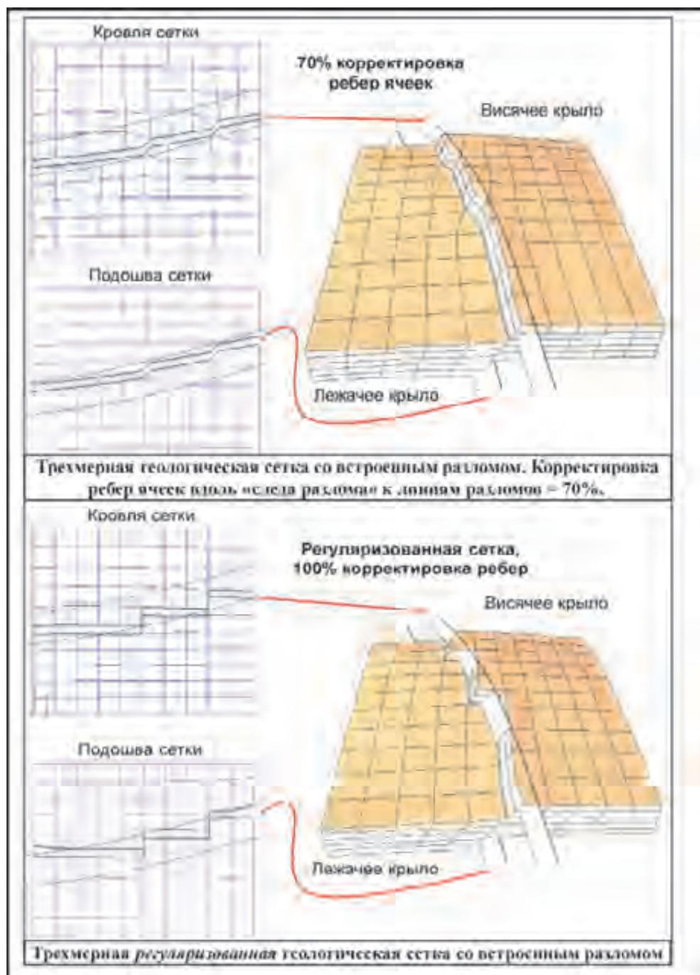
Рис.П.3.12. Встраивание разлома в сетку – второй пример
