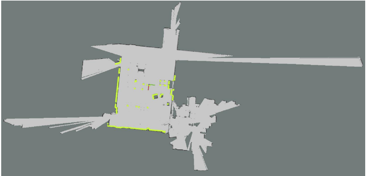
Рисунок 1.6 – Результат работы скан матчера: сопоставленные лазерный скан и карта для вычисления текущей позиции
