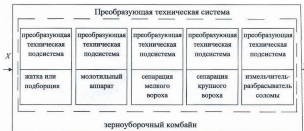
Рис. 2 – Зерноуборочный комбайн как преобразующая техническая система
