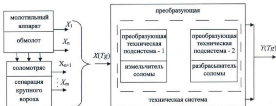
Рис. 3 – Структурная модель измельчителя-разбрасывателя соломы как преобразующей технической подсистемы зерноуборочного комбайна
