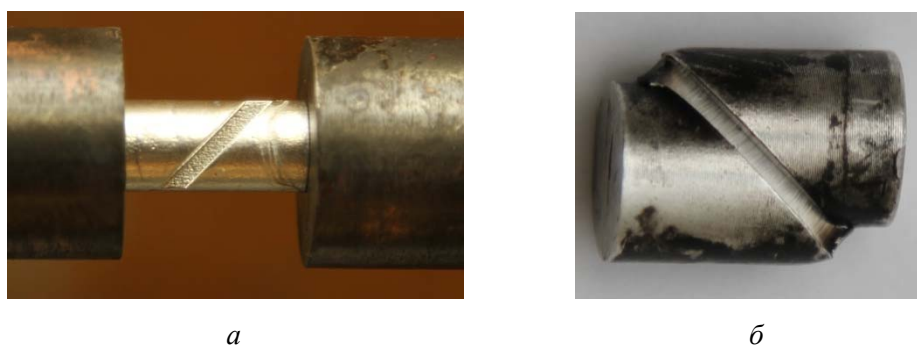
Рис. 5. Образец «сдвиг-сжатие» между входным и выходным стержнями Гопкинсона-Кольского (а) и после деформирования (б)
