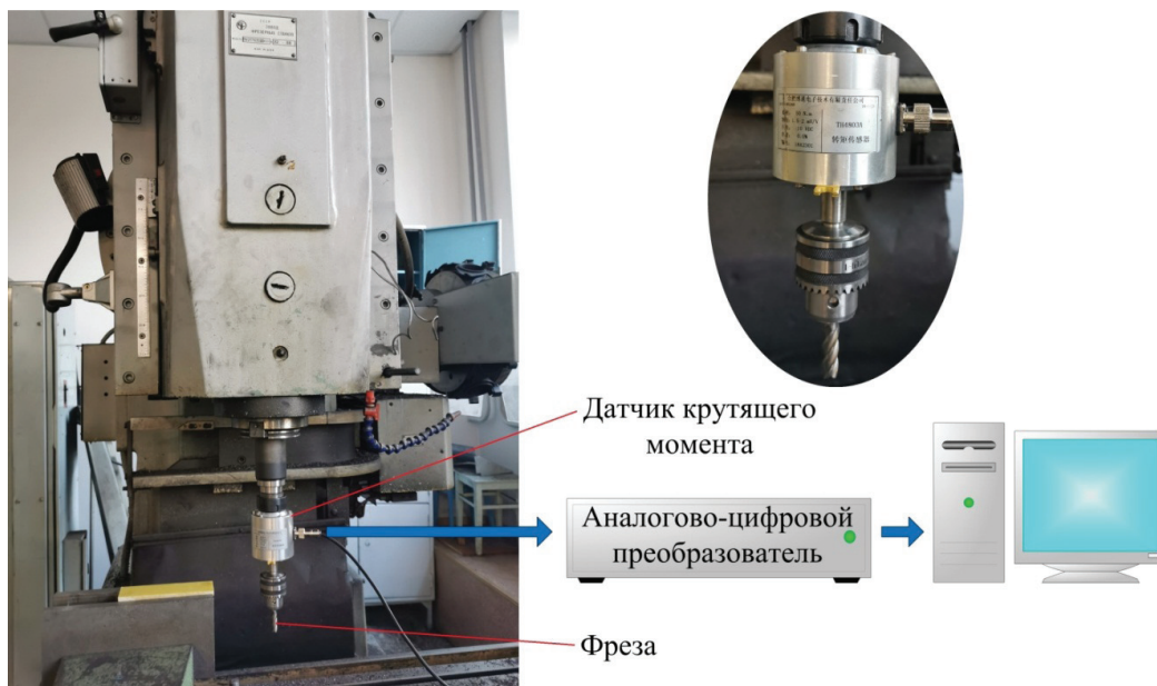
Рис. 1. Принципиальная схема экспериментальной установки Fig. 1. Schematic diagram of the experimental assembly
