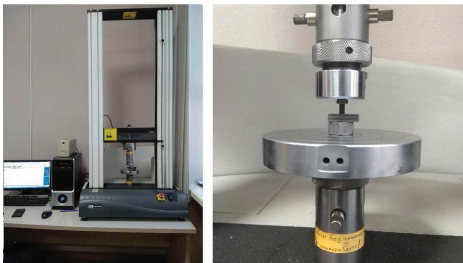
*Рис. 2. Испытание прочности резьбового соединения (испытательная машина 3369 Instron)*
