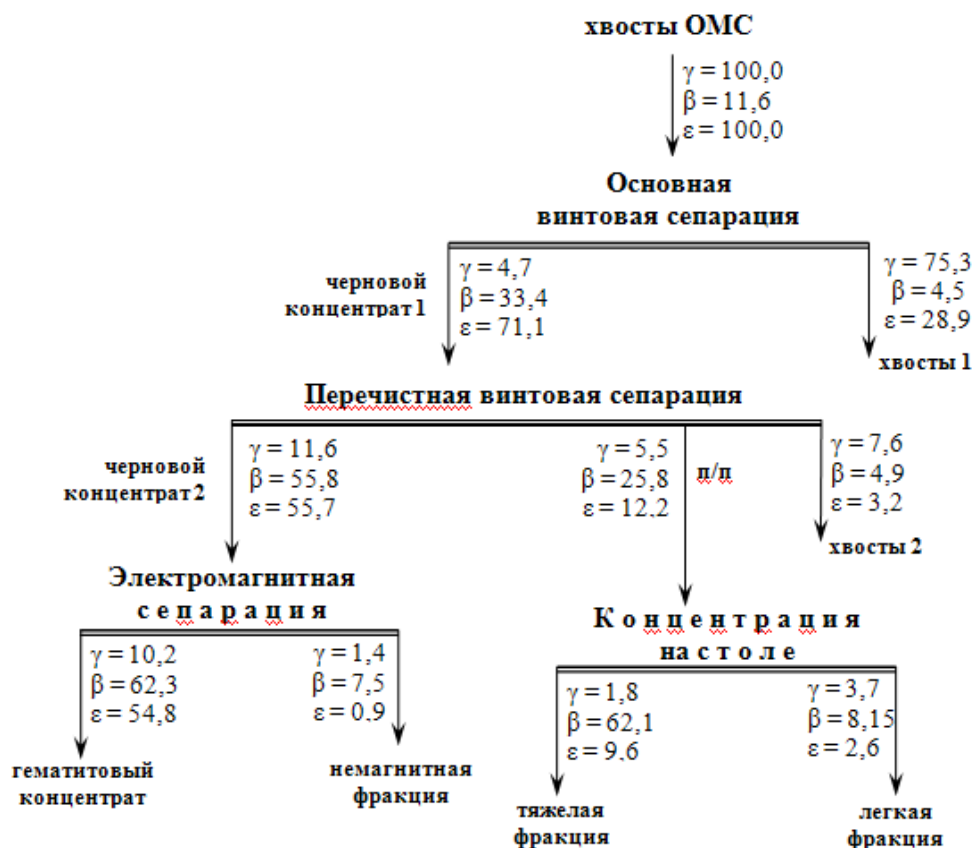
Рис 3. Технологическая схема получения гематитового концентрата из хвостов основной магнитной сепарации
