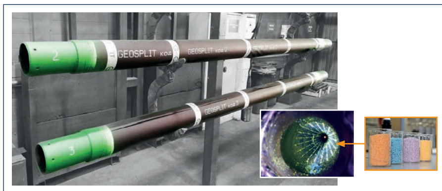
Рис. 4. Внутрискважинная кассета с маркированным композиционным материалом
