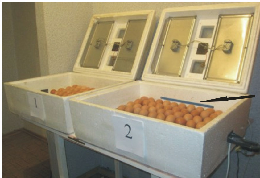
Рис. 2. Инкубаторы бытовые «Золушка» (слева — немодифицированный, справа — снабженный ограничительными пластинами, последняя показана стрелкой)
