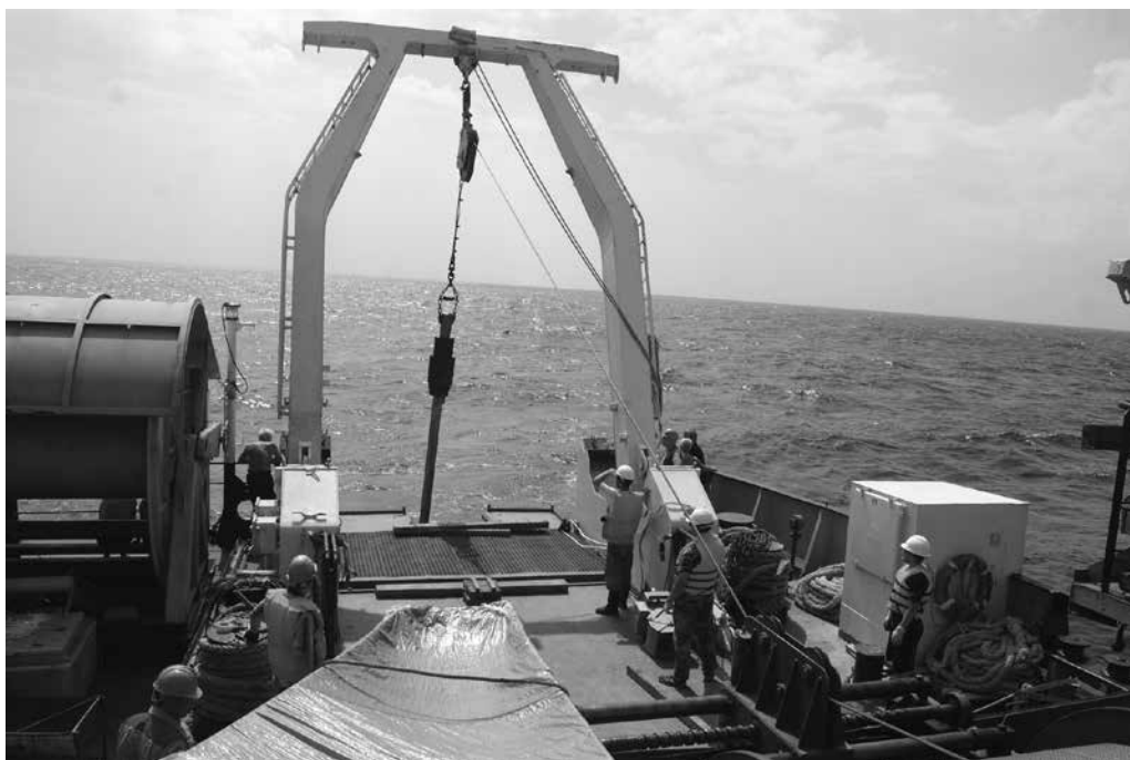
Подъем геологического гравитационного колонкового пробоотборника. Фото предоставил А.И. Обжиров
