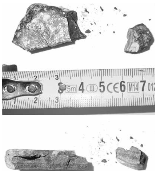
Рис. 2. Железомарганцевые корки (станция LV88-9GC). Фото В.Ю. Калгина
