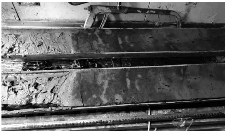
Фрагмент керна осадочных отложений с обильными проявлениями гидротроилита (индикатор биогенной сульфатредукции)
