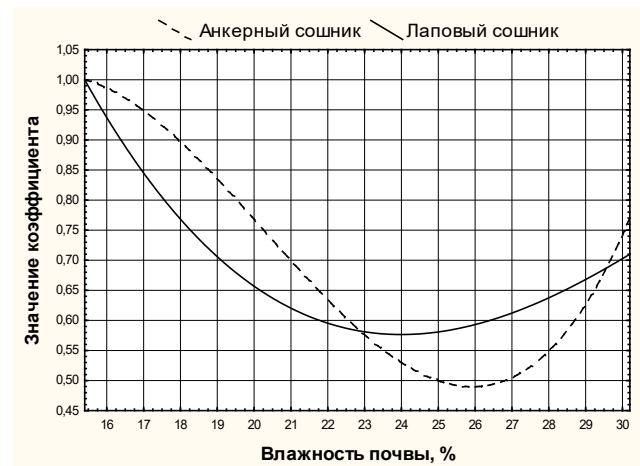
Рис. 3 – Изменение коэффициента K_W^{E_0} , учитывающего влияние влажности почвы, на интенсивность прироста расхода топлива тракторного двигателя
