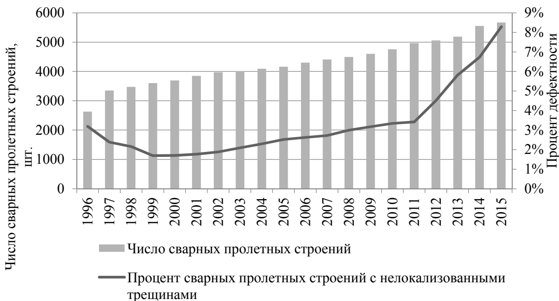
Рис. 1. Динамика изменения количества сварных пролетных строений на сети железных дорог ОАО «РЖД»
