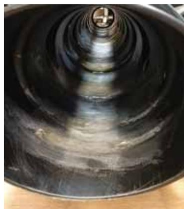
Рис. 2. Трубопровод системы АСО Qmax с имитацией частичного заиливания придонной части
