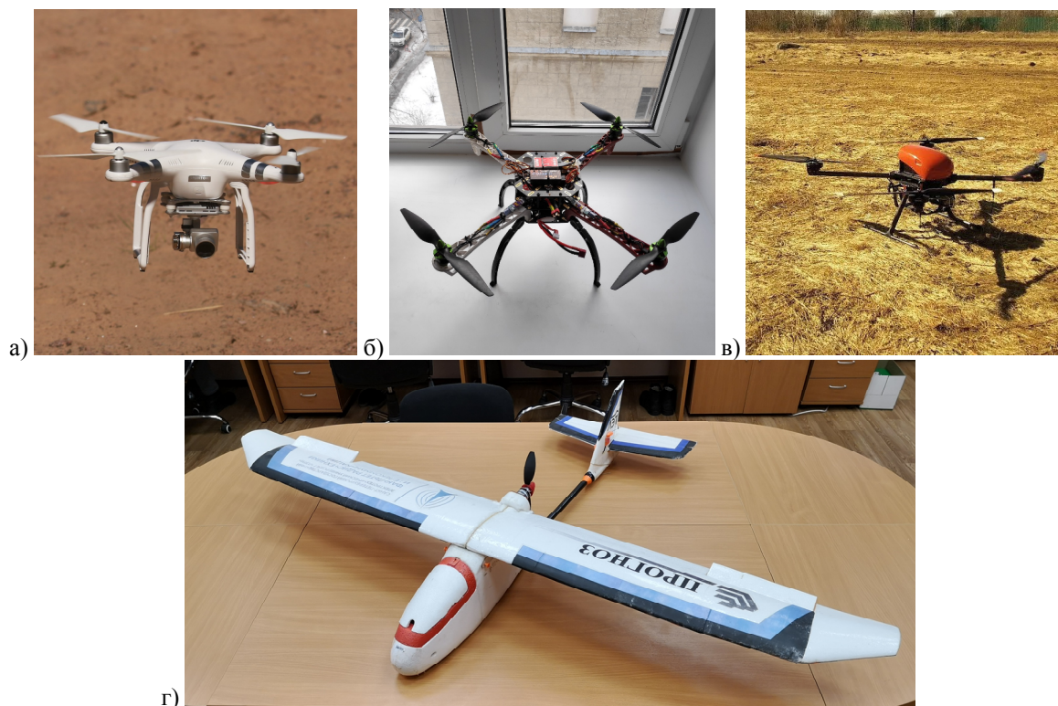
Рис.2. Фото экспериментальных БПЛА: квадрокоптер DJI Phantom 3 (а), квадрокоптер на базе DJI F450 (б), квадрокоптер Geoscan 410 (в), и одновинтовой БПЛА самолетного типа Skywalker 190 (г)
