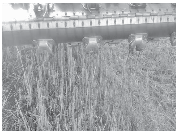
Рис. 4 – Деформация пружинных пальцев транспортёрного подборщика зерноуборочного комбайна «ACROS-530»
