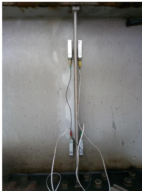
Рис. 1. Расположение тензометрических датчиков на стенке продольной балки проезжей части
