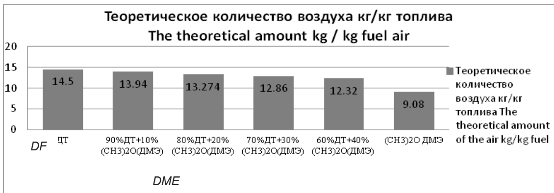
Рис. 4. Теоретическое количество воздуха кг/кг топлива Fig. 4. Theoretical amount of the air kg/kg fuel
